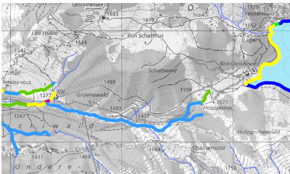
Abbildung 7: Ökomorphologie der Fließgewässer im Gebiet Oeschinen. Der Sulgrabe ist im Bereich des Kraftwerkgebäudes stark beeinträchtigt (gelb), resp. eingedolt (violett).
