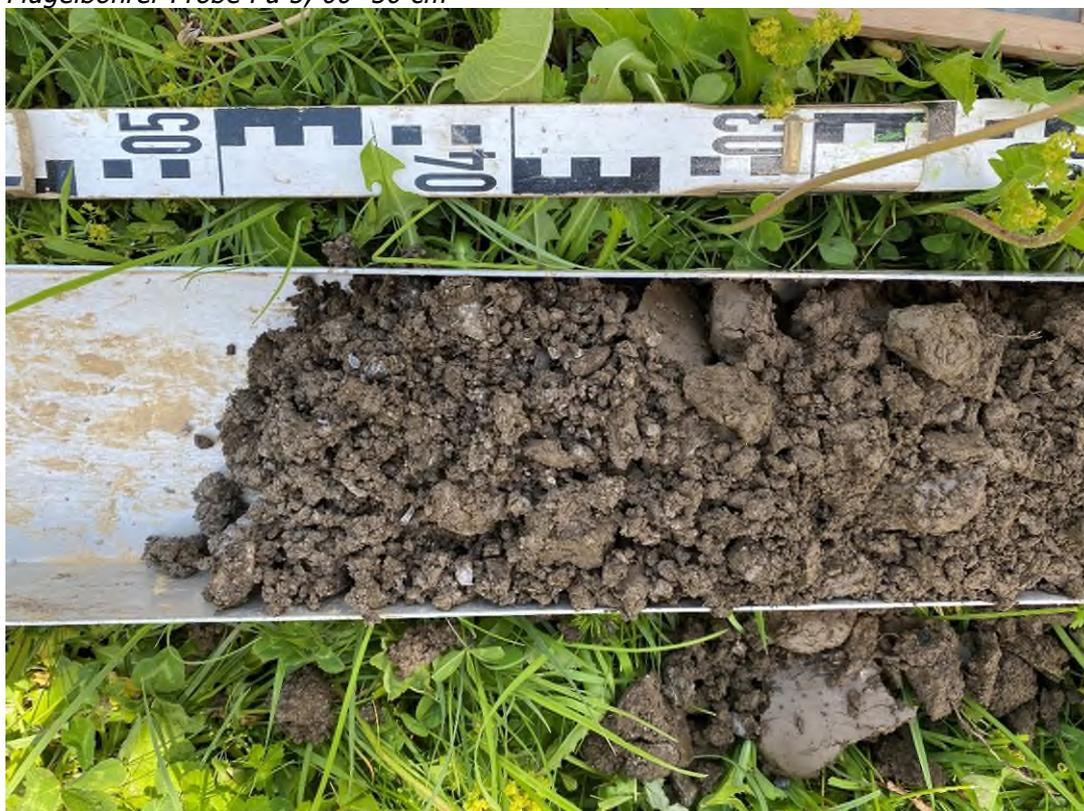
*Flügelbohrer Probe Pu 5, 30 - 50 cm*
