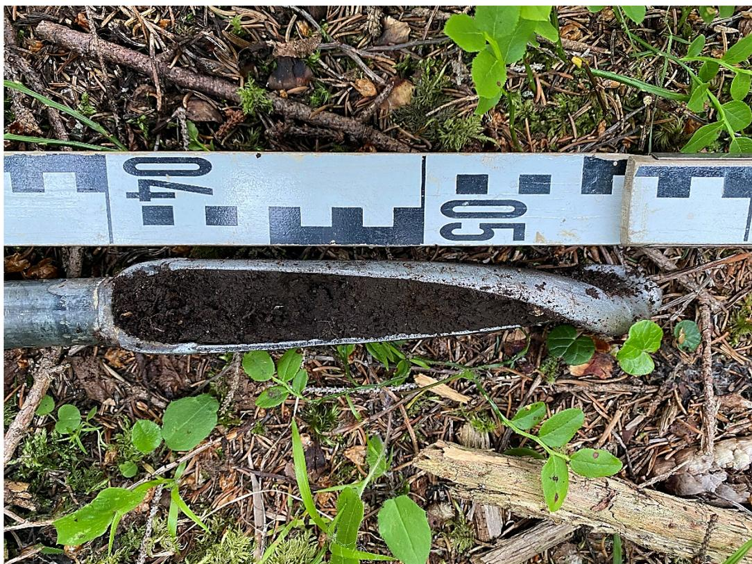
Flügelbohrer Probe Pu 2, 40 - 55 cm
