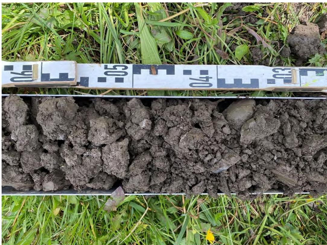
*Flügelbohrer Probe Pu 3, 30 - 60 cm*
