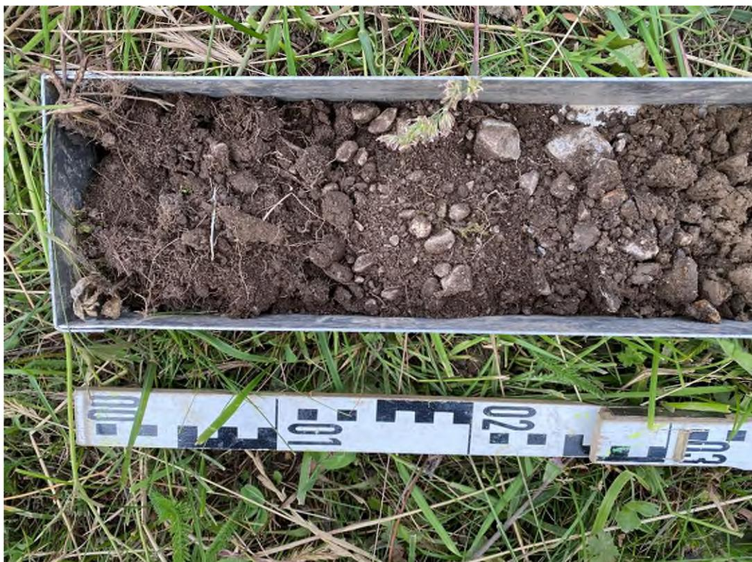
*Flügelbohrer Probe Pu 8, 00 - 30 cm*
