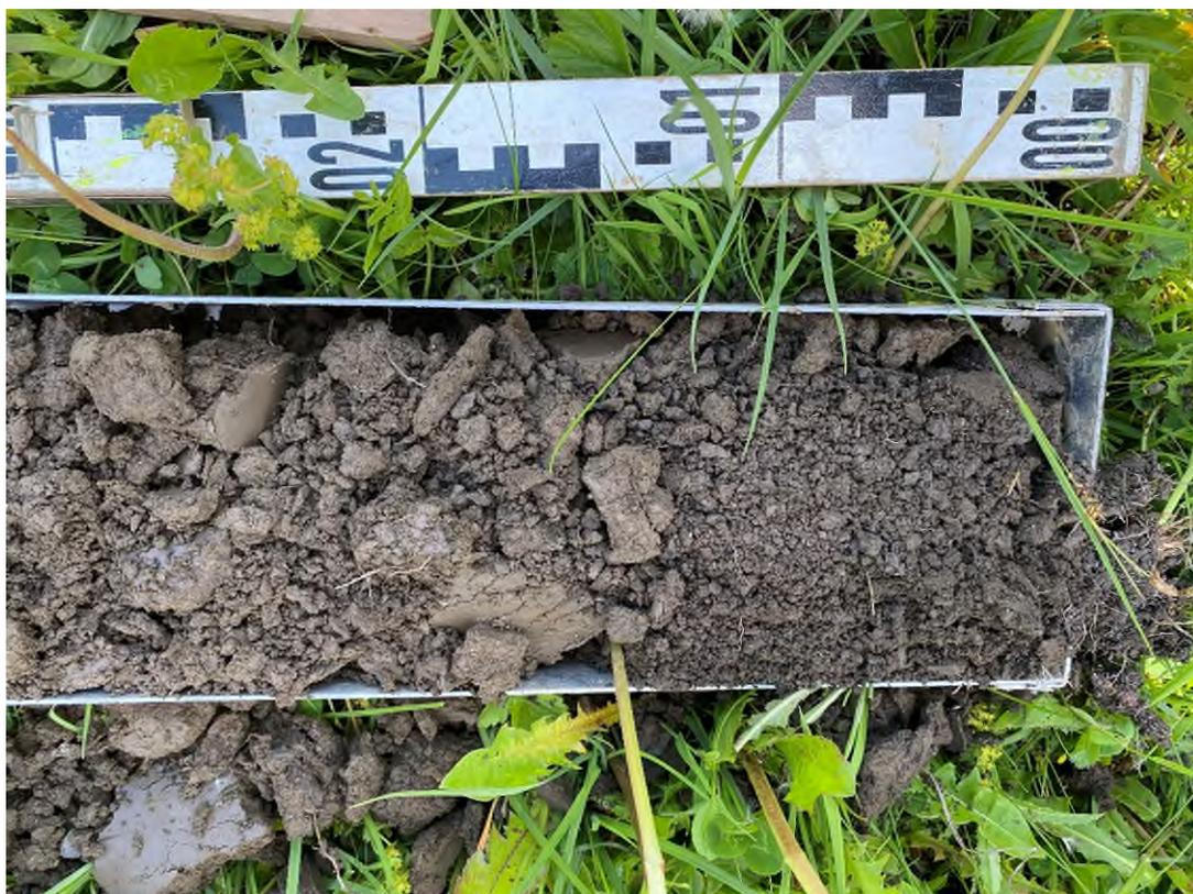
*Flügelbohrer Probe Pu 5, 00- 30 cm*
