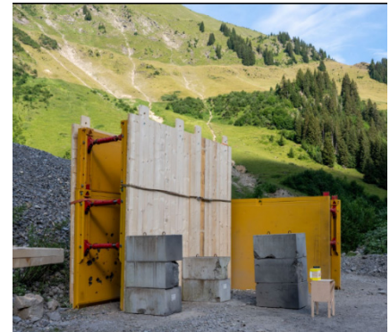
Testaufbau für Sprengversuche an Splitterschutzwänden
