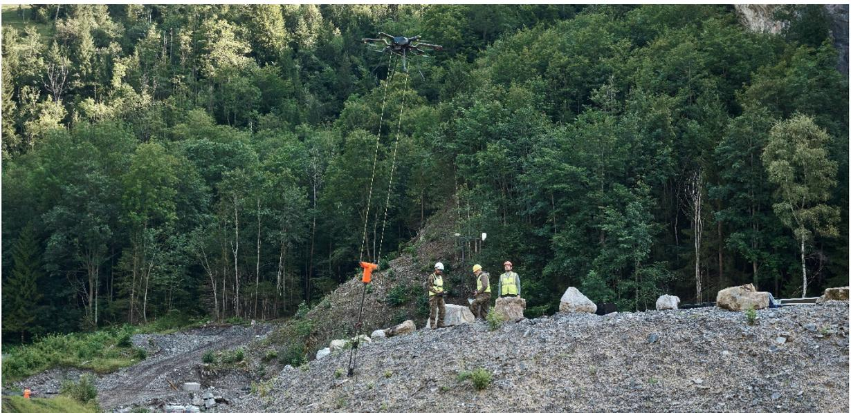
Munitionsdetektion mittels Spezialdrohne im August 2024
