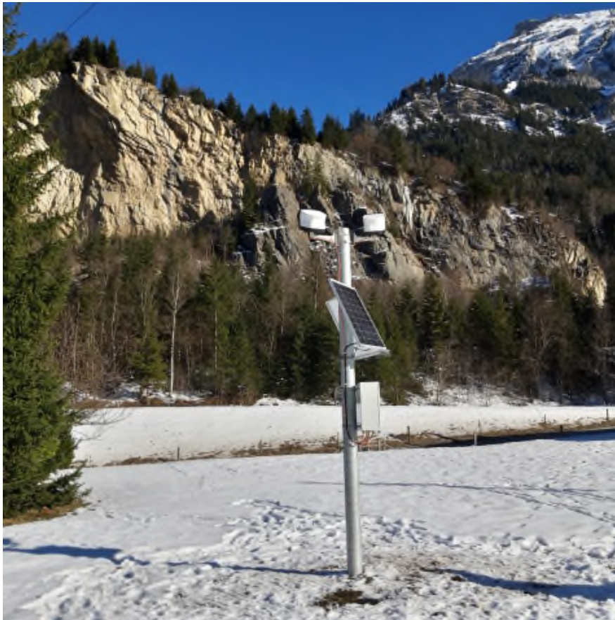
Installationen der Kameras für die Mono-Photogrammetrie im Februar 2023
